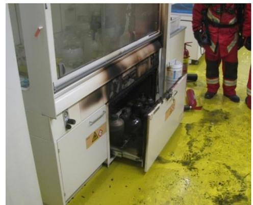
Löschmitteln konnte der Brandschaden sehr klein gehalten und Folgeschäden durch den Löscheinsatz vermieden werden. Trotz Überdruckbelüftung konnte ein relativ grosser Rauchschaaden, vor allem an Laborgeräten, nicht verhindert werden.
