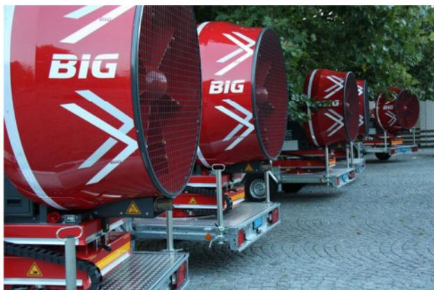
In der Regel müssen bei Grossbauten die Untergeschosse maschinell entraucht werden. Die Installation einer solchen Anlage ist sehr kostspielig. Wenn mobile Grosslüfter der Feuerwehren aber 15 Minuten nach Eingang eines Alarms vor Ort sein können, kann je nach Entrauchungskonzept bis und mit dem ersten Untergeschoss auf den Einbau einer maschinellen Rauch- und Wärmeabzugsanlage verzichtet werden. Die AGV hat mit der Anschaffung der acht Grosslüfter nun diese Voraussetzungen geschaffen.
