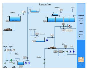
Anschliessend erfolgt die Überprüfung der Fernsteuerungsanlage nach folgen Punkten: Notstromversorgung, Telealarm, Löschwassermengen, Löschklappen und Sicherheitszuschläge. Wenn die Löschreserve nicht über die Steuerung abgesichert ist, werden die Löschklappen geöffnet.
