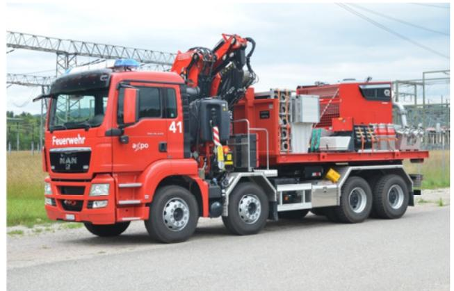
Wechselladerfahrzeug mit einem 31 m/t Kran und einem 21 t Hackengerät. Beladen mit einer Wassertransportpumpe, welche bei 10 Bar 10'000 l/min fördert
