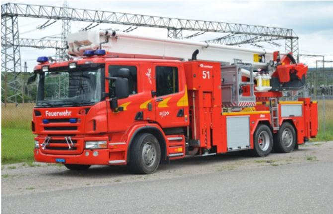
Hubretter mit einer Rettungshöhe von 32 m, einer 500 kg Korblast und einem Wasserwerfer mit 4500 l/min Leistung
