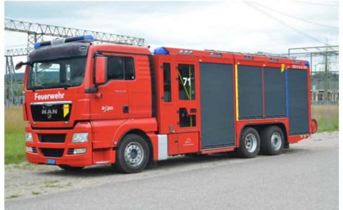
Universallöschfahrzeug mit 7000 l Wasser, 2000 l Schaum und 180 kg CO<sub>2</sub>. Zusätzlich ausgerüstet mit einer CAFS-Anlage, einem 4500 l/min Wasserwerfer und einer 7600 l/min Pumpe
