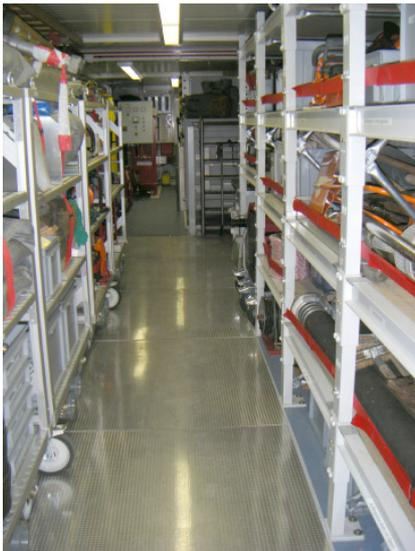
Im Container des Gerätefahrzeugs befinden sich vielerlei Gerätschaften für Umwelt-, Rettungs- und Löscheinsätze wie zum Beispiel Auffangbecken, Pionierwerkzeuge, Pumpen und Generatoren.
