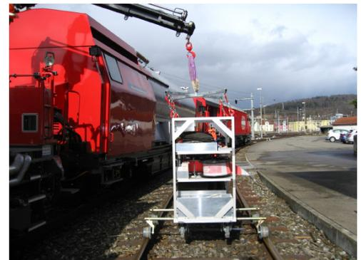
Auf kleinen Wagen befinden sich Hilfskupplungen zum Abschleppen von Zügen. Im hinteren Teil des Containers stehen ein 52 kVA Generator für das Bordnetz, ein Atemluftkompressor mit Abfüllstation für Atemluftflaschen und ein Tableau für die Luftversorgung des Gerätefahrzeuges.
