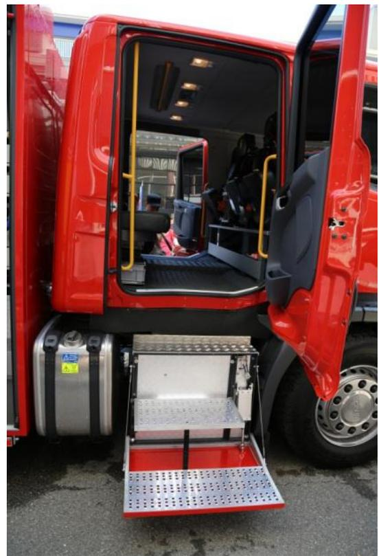
Der breite Einstieg und die ausladende, selbst ab-/einklappende Treppe bieten Sicherheit für die AS-Geräteträger
